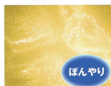
微弾性フィラー+ 一般外壁用水性塗料(つや有り) 2回塗り なみがた仕上げ
